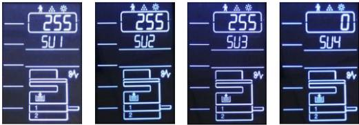
**9** 子网掩码设置完毕后，按“倍率选择”键切换至“网关”dE1状态。
